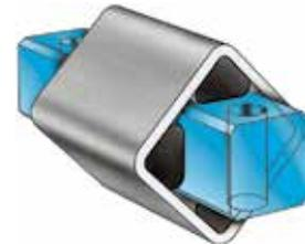
Fig. 16 Carré intérieur plein rallongé avec trous débouchants aux extrémités
