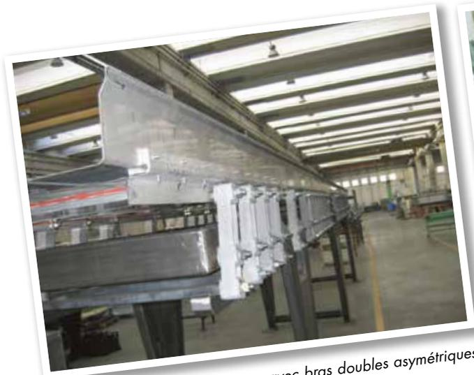
Système à 2 masses à résonance avec bras doubles asymétriques en fonte aluminium
