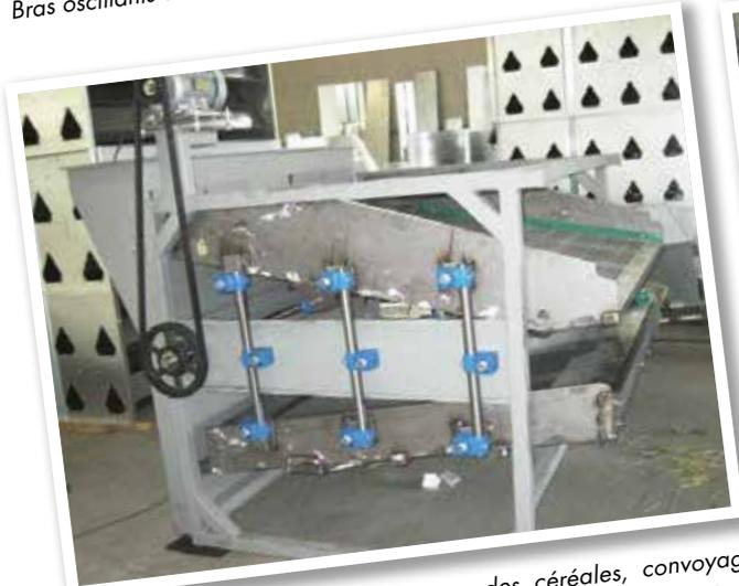
Système oscillant pour le nettoyage des céréales, convoyage bidirectionnel avec bras doubles équipés d'éléments AR (montage «boomerang»)
