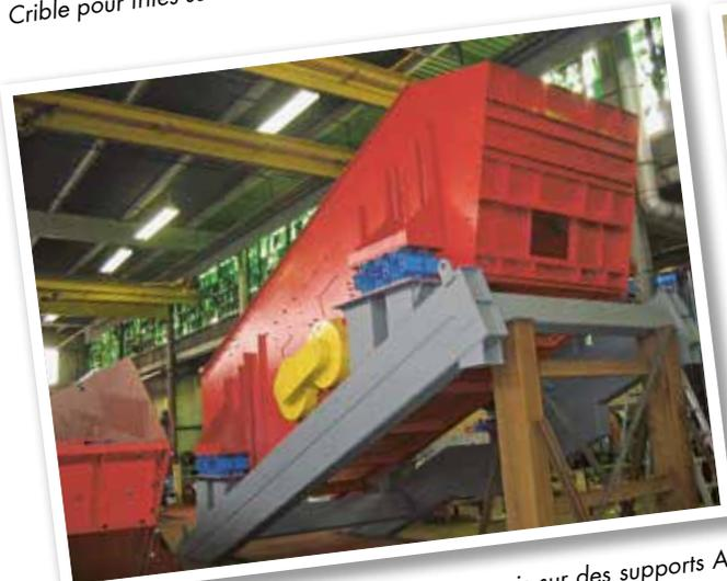
Crible à oscillations circulaires pour minerais sur des supports AB-TWIN.
