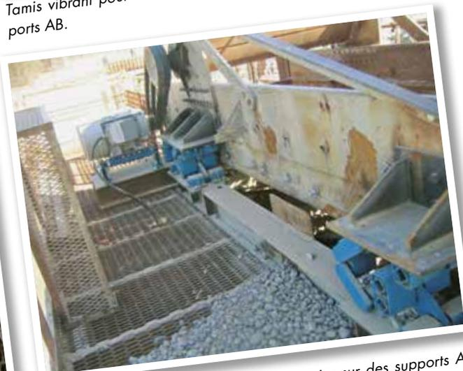
Crible à oscillations circulaires pour gravier sur des supports AB-TWIN.
