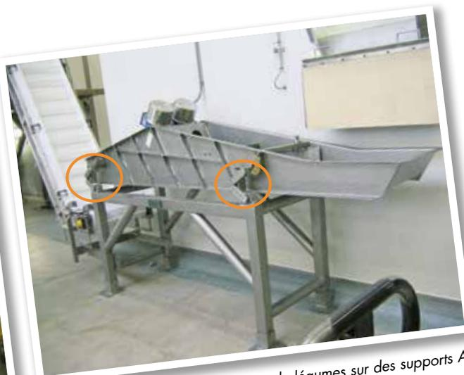
Convoyeur vibrant pour le transport de légumes sur des supports AB (acier inox).
