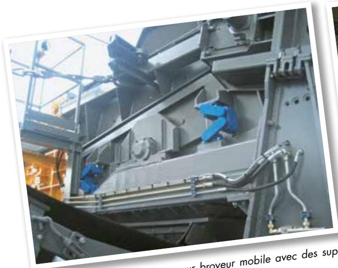
Crible à oscillations circulaires sur broyeur mobile avec des supports AB.
