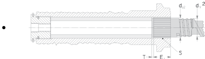
Ejecución HB: tornillo extrusora ensamblado con perfil acanalado
