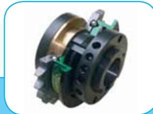
Accouplement de sécurité à billes simple et compact, avec billes directement insérées dans l'organe de transmission. Le découplage se produit à l'atteinte du couple d'étalonnage réglé de façon rapide et sécurisée.
