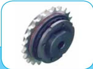
Accouplement de sécurité à glissement, avec organe de transmission monté entre deux bagues de frottement coulissant à l'atteinte du couple d'étalonnage réglé. Le minimum pour avoir une protection à bas coût.
