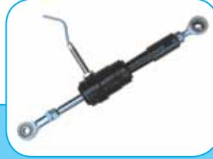
Accouplement de sécurité à limitation linéaire de la force. Le découplage axial peut avoir lieu aussi bien en compression qu'en traction à l'atteinte de la force d'étalonnage réglée. Le réarmement est automatique.
